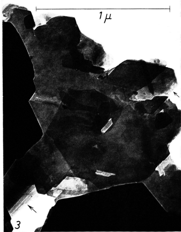
Abb. 1. Unkontrastierte Kaolinit- und Halloysit-Metahalloysit-Kristalle; Aufstäubepräparat. El.-opt. Vergr. 20 000 ×; Endvergr. 130 000 ×.
