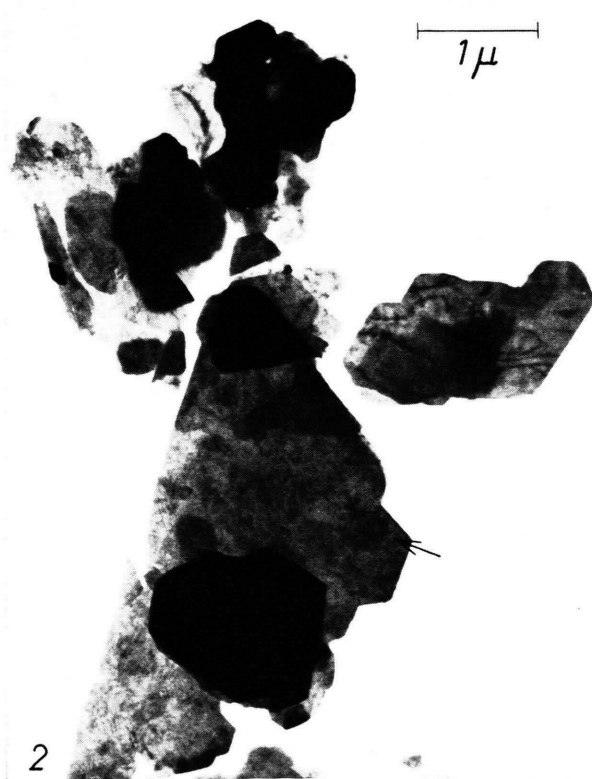
Abb. 1. Unkontrastierte Kaolinit- und Halloysit-Metahalloysit-Kristalle; Aufstäubepräparat. El.-opt. Vergr. 20 000 ×; Endvergr. 130 000 ×.
